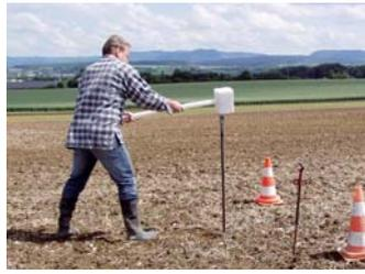
Entnahme von Bodenproben mit Hilfe des Pürckhauer Bohrstockes.
