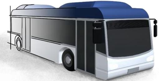
Nur Brennstoffzellen- und Batteriefahrzeuge gelten als emissionsfrei. Tendenziell sind erstere für höhere und letztere für geringere Fahrzeuggewichte sowie Reichweiten- und Leistungsanforderungen geeignet.
