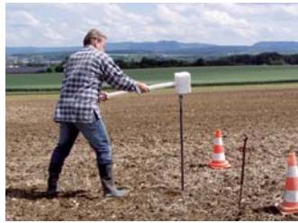
Grundwassermessstelle zur Überwachung der Grundwasserqualität.
