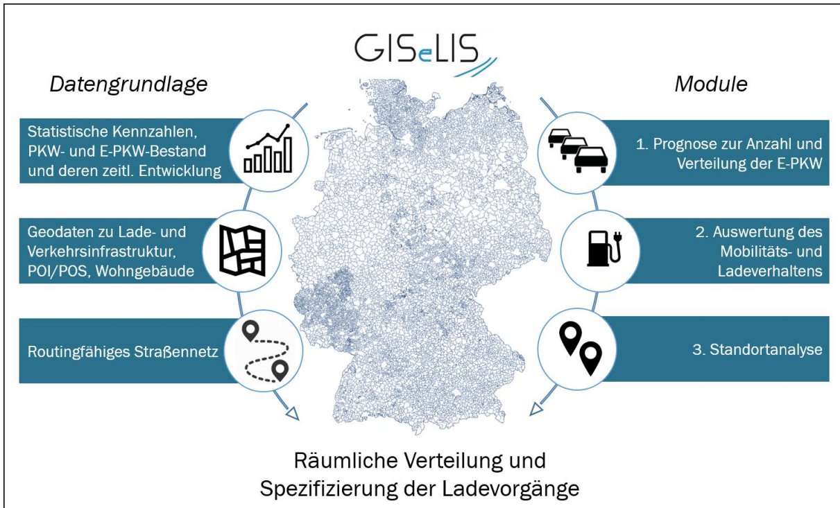
Abbildung 11: Funktionsweise des Standortmodelles für Ladeinfrastruktur GISeLIS
